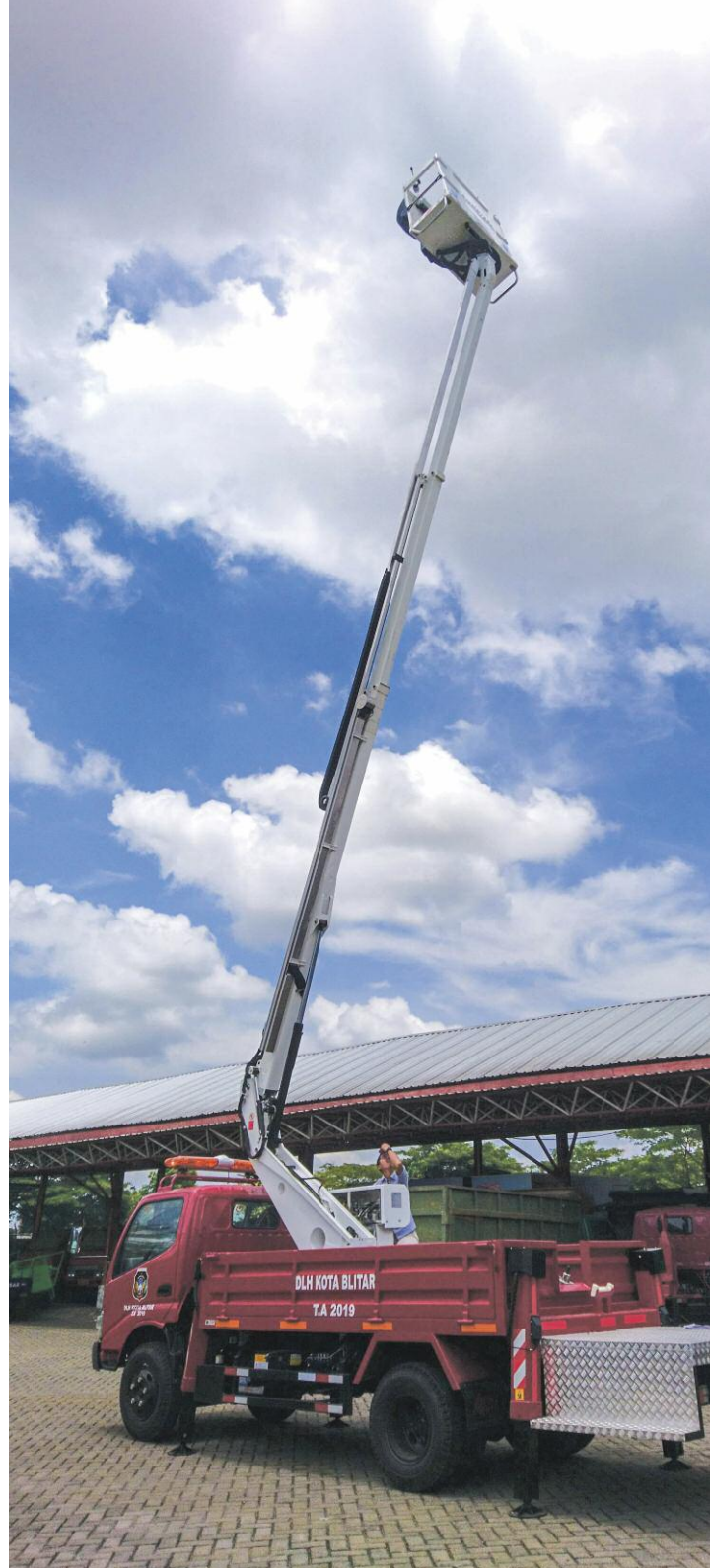
Boom teleskopik 18 meter
