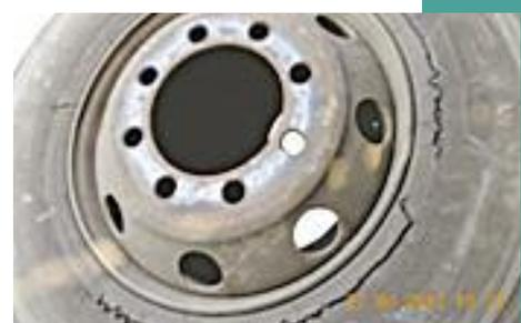
Bead Crack Outer (Bead Retak Bagian Luar)
