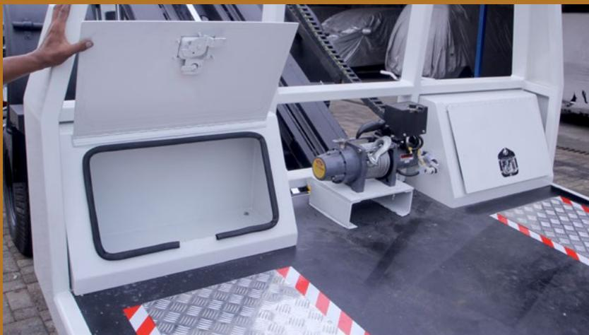
Kotak penyimpanan di samping kanan dan kiri winch roll, bisa digunakan untuk belt dan stopper roda
