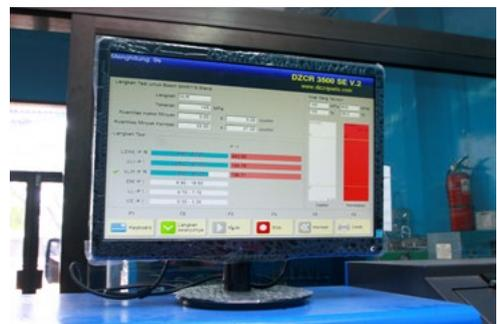
Perangkat tester komponen injection pump
