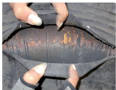
Sidewall separation (dinding samping mengelupas)
