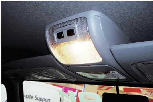
Lampu kabinnya tersedia switch buat menyetel mode door close/door open
