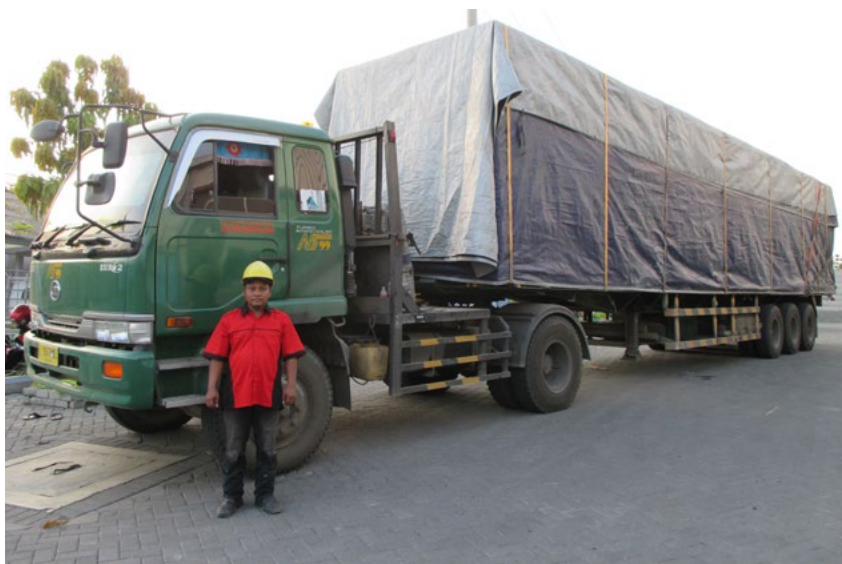
Persiapan sebelum berangkat sopir dan pembantu sopir memeriksa pengamanan muatan sesuai SOP
