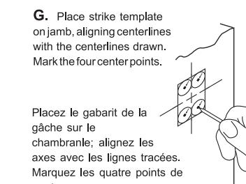
Coloque la plantilla de la plancha de cerradura en la jamba, alineando las líneas de centro con las líneas del centro que se trazaron. Marque los cuatro puntos centrales.
