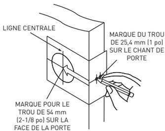
Mesurez la ligne centrale de la serrure; mesurez la hauteur comme désiré à partir du plancher fini. Choisissez la distance d'entrée de 2-3/4 po ou la distance d'entrée optionnelle de 2-3/8 po, pliez et appliquez le gabarit sur le côté intérieur de la porte et marquez le centre de la porte comme indiqué sur le gabarit. Marquez le trou central sur la face de la porte à l'aide du guide sur le gabarit.
