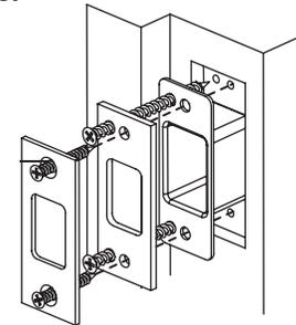
Alignez les trous de vis sur la gâche avec les lignes centrales verticales sur le montant. Marquez le contour de la gâche et ciselez une ouverture de 6,4 mm (1/4 po) de profondeur pour que la boîte à poussière, le renfort du cadre de bois et la gâche soient à ras. Placez la boîte à poussière, le renfort du cadre de bois dans la mortaise et fixez sur le cadre en utilisant des vis à bois de 3 po. Insérez la gâche et fixez-la au cadre avec les vis no 8.
