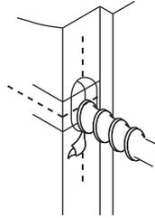
Percez (2) trous de 25,4 mm (1 po) à 31,7 mm (1-1/4 po) de profondeur dans le montant de porte, à 8 mm (5/16 po) au-dessus et à 8 mm (5/16 po) en dessous de la ligne centrale horizontale.
