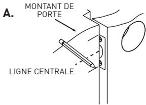
Fermez la porte. Localisez la gâche dans le montant et la ligne centrale de la gâche. Ouvrez la porte et prolongez la ligne jusqu'à la butée de la porte. Mesurez la moitié de l'épaisseur de la porte plus 1/8 po à partir de la butée de porte. Marquez verticalement la ligne centrale pour la gâche.
