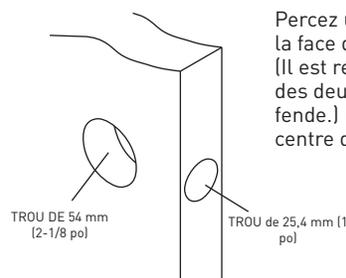
Percez un trou de 54 mm (2-1/8 po) au travers de la face de la porte, tel qu'indiqué pour la serrure. (Il est recommandé de percer des trous à partir des deux côtés afin d'éviter que le bois ne se fende.) Percez un trou de 25,4 mm (1 po) dans le centre du chant de porte pour le loquet.
