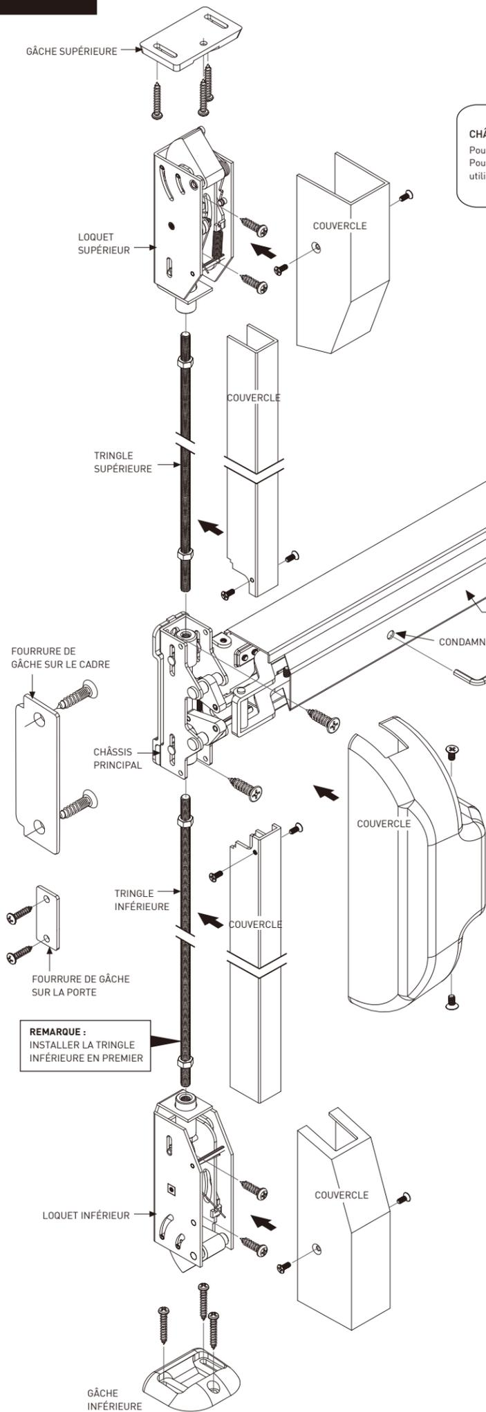
**CHÂSSIS PRINCIPAL ET VIS DE MONTAGE POUR LOQUETS SUPÉRIEUR ET INFÉRIEUR**
