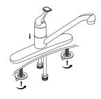
4 En travaillant sous l'évier, vissez les écrous de montage (n° 15) sur les boulons (n° 14) et serrez.
