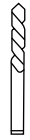
Drill with Ø 1/4" (6 mm) bit Ø 1/8" (3.2 mm) bit Ø 1/16 (1.6 mm) bit Perceuse avec mèche de Taladro con broca de Ø 6 mm (1/4 po/pulg.) Ø 3,2 mm (1/8 po/pulg.) Ø 1,6 mm (1/16 pulg.)
