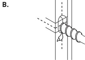
Percez (2) trous de 25,4 mm (1 po) à 31,7 mm (1-1/4 po) de profondeur dans le montant de porte, à 8 mm (5/16 po) au-dessus et à 8 mm (5/16 po) en dessous de la ligne centrale horizontale.
