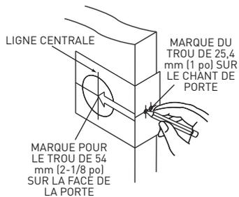
Mesurez la ligne centrale de la serrure; mesurez la hauteur comme désiré à partir du plancher fini. Choisissez la distance d'entrée de 2-3/4 po ou la distance d'entrée optionnelle de 2-3/8 po, pliez et appliquez le gabarit sur le côté intérieur de la porte et marquez le centre de la porte comme indiqué sur le gabarit. Marquez le trou central sur la face de la porte à l'aide du guide sur le gabarit.
