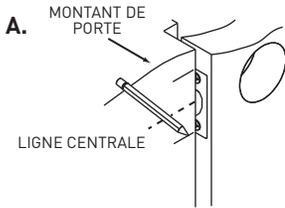
Fermez la porte. Localisez la gâche dans le montant et la ligne centrale de la gâche. Ouvrez la porte et prolongez la ligne jusqu'à la butée de la porte. Mesurez la moitié de l'épaisseur de la porte plus 1/8 po à partir de la butée de porte. Marquez verticalement la ligne centrale pour la gâche.
