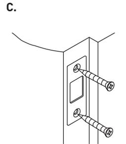
Insérez la gâche et fixez-la au cadre avec les vis no 8.
