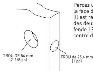
Percez un trou de 54 mm (2-1/8 po) au travers de la face de la porte, tel qu'indiqué pour la serrure. (Il est recommandé de percer des trous à partir des deux côtés afin d'éviter que le bois ne se fende.) Percez un trou de 25,4 mm (1 po) dans le centre du chant de porte pour le loquet.
