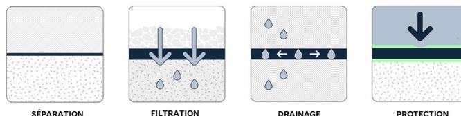
MIRAFI<sup>MD</sup> S3200 est un géotextile non tissé aiguilleté composé de fibres de polypropylène, qui sont formées en un réseau stable de sorte que les fibres conservent leur position relative. Le géotextile MIRAFI S3200 est inerte à la dégradation biologique et résiste aux produits chimiques, aux alcalis et aux acides présents dans la nature.
