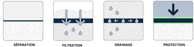
MIRAFI<sup>MD</sup> S2400 est un géotextile non tissé aiguilleté composé de fibres de polypropylène, qui sont formées en un réseau stable de sorte que les fibres conservent leur position relative. Le géotextile MIRAFI S2400 est inerte à la dégradation biologique et résiste aux produits chimiques, aux alcalis et aux acides présents dans la nature.
