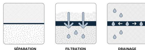
MIRAFI® 1100NC est un géotextile non tissé aiguilleté composé de fibres de polypropylène, qui sont formées en un réseau stable de sorte que les fibres conservent leur position relative. Le géotextile MIRAFI 1100NC est inerte à la dégradation biologique et résiste aux produits chimiques, aux alcalis et aux acides présents dans la nature.
