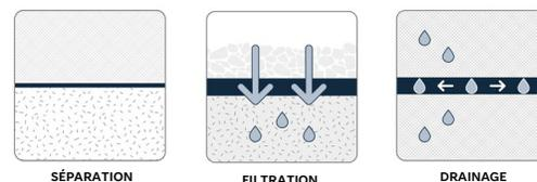
MIRAFI<sup>MD</sup> 140N est un géotextile non tissé aiguilleté composé de fibres de polypropylène, qui sont formées en un réseau stable de sorte que les fibres conservent leur position relative. Le géotextile MIRAFI 140N est inerte à la dégradation biologique et résiste aux produits chimiques, aux alcalis et aux acides présents dans la nature. Le géotextile MIRAFI 140N est conforme à la norme AASHTO M288, classe de résistance 3 pour un allongement de < 50 %.
