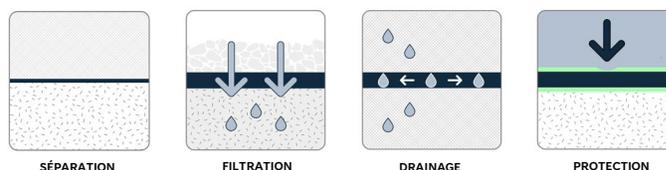
MIRAFI<sup>MD</sup> S1200 est un géotextile non tissé aiguilleté composé de fibres de polypropylène, qui sont formées en un réseau stable de sorte que les fibres conservent leur position relative. Le géotextile MIRAFI S1200 est inerte à la dégradation biologique et résiste aux produits chimiques, aux alcalis et aux acides présents dans la nature.
