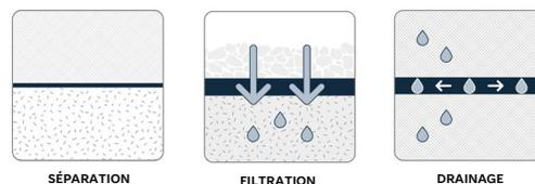
MIRAFI® 1100NPA est un géotextile non tissé aiguilleté composé de fibres de polypropylène, qui sont formées en un réseau stable de sorte que les fibres conservent leur position relative. Le géotextile MIRAFI 1100NPA est inerte à la dégradation biologique et résiste aux produits chimiques, aux alcalis et aux acides présents dans la nature.
