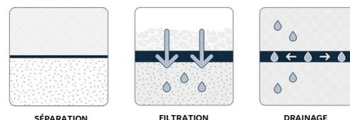
MIRAFI<sup>MD</sup> E1200 est un géotextile non tissé aiguilleté composé de fibres de polypropylène, qui sont formées en un réseau stable de sorte que les fibres conservent leur position relative. Le géotextile MIRAFI E1200 est inerte à la dégradation biologique et résiste aux produits chimiques, aux alcalis et aux acides présents dans la nature.
