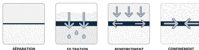
Le géotextile MIRAFI<sup>MD</sup> HP370 est composé de fils de polypropylène monofilament à haute ténacité, qui sont tissés en un réseau de sorte que les fils conservent leur position relative. Le géotextile MIRAFI HP370 est inerte à la dégradation biologique et résiste aux produits chimiques, aux alcalis et aux acides présents dans la nature.
