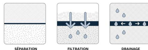
MIRAFI® 180NC est un géotextile non tissé composé de fibres de polypropylène, qui sont formées en un réseau stable de sorte que les fibres conservent leur position relative. Le géotextile MIRAFI 180NC est inerte à la dégradation biologique et résiste aux produits chimiques, aux alcalis et aux acides présents dans la nature.
