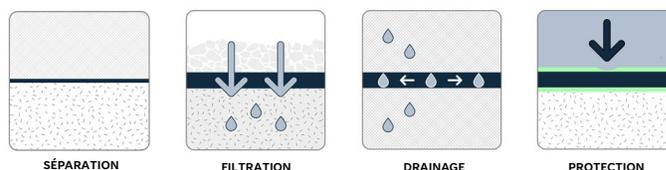
MIRAFI<sup>MD</sup> S800 est un géotextile non tissé aiguilleté composé de fibres de polypropylène, qui sont formées en un réseau stable de sorte que les fibres conservent leur position relative. Le géotextile MIRAFI S800 est inerte à la dégradation biologique et résiste aux produits chimiques, aux alcalis et aux acides présents dans la nature.
