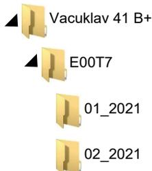
O autoclave verifica, pois, em cada tipo da emissão de protocolos (emissão imediata após ciclo percorrido ou transferência de vários protocolos de uma só vez) o suporte de armazenamento e cria automaticamente um diretório do aparelho e do mês em caso de inexistência. Se os protocolos forem emitidos repetidamente para o mesmo suporte de armazenamento, será criado aí, sob o diretório de aparelhos, um diretório com o nome "Duplicado".
