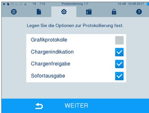
**Chargenindikation** umfasst die Überprüfung der im Aufbereitungsprogramm mitgeführten Indikatoren, z. B. MELAcontrol Helix oder MELAcontrol Pro. Nur bei einem vollständigen Farbumschlag der Indikatorstreifen kann die Freigabe der Indikatoren erfolgen.
