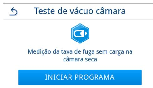
4. Aguarde até o teste de vácuo ter sido concluído. Durante o teste de vácuo, a pressão de evacuação, a temperatura e o fim provável do teste de vácuo aparecem no visor.
