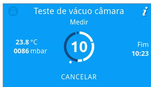
5. Após o tempo de medição, a câmara de esterilização é ventilada. De seguida, é apresentada a mensagem com informação da taxa de fuga no visor. Depois de concluir com sucesso o programa, o LED de estado do aparelho (LED esquerdo) acende a verde e soa uma vez um sinal acústico.
