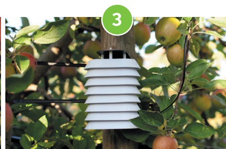
Cubierta con sensores de temperatura e higrometría
