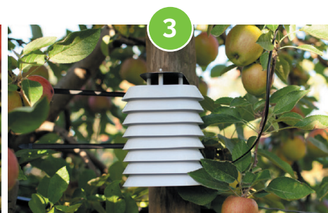
Kap met temperatuur- en luchtvochtigheidssensoren
