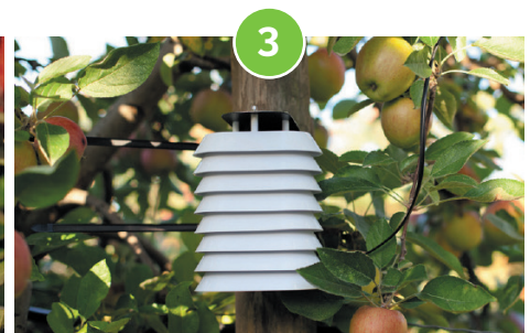
Schutzgehäuse für Temperatur- und Luftfeuchtigkeitssensoren
