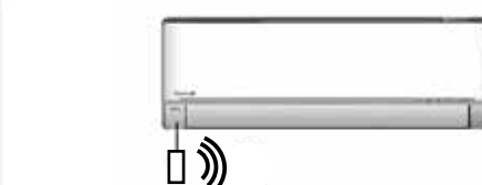
Wifi-sovitin CZ-TACG1 asennetaan pumpun sisään tai viereen.
