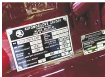
Tyyppikilpi kertoo, että noihin aikoihin moottorin ja rungon sarjanumerot olivat samat. Jopa moottorin teho löytyy kilvestä.
