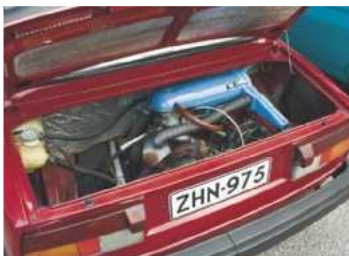
Moottorin kansi on yhtä ahdas kuin useiden nykyautojen tavaratilan luukku: tästä piti alunperin tulla kontti. Polttonestesäiliökin on valmiiksi takana.
