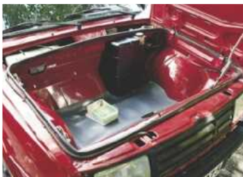
Tavaratila aukeaa erikoisella tavalla sivusuunnassa. Keulalla on jäähdytin ja kuljettajan edessä kotelo, joka peittää jarru- ja kytkinmekanismit.
