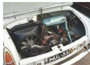
Ensimmäisen polven takatuupparissa on kaikki takana aina lämmityslaitetta myöten. Moottori on uutuus vuodelta 1964.
