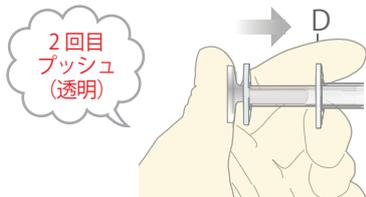
注意2：小プランジャーをしっかり最後まで押し込まないと透明シリンジ内の赤い液体が赤色シリンジ内に移動されませんので、その後のミキシング操作（下記）を行っても2液が混合されません。
