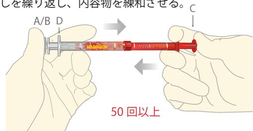
7. 内容物を全てシリンジ（赤）内に移動させた状態でシリンジ（透明）を取り外す。
