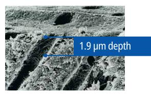
El ácido fosfórico Ultra-Etch ha demostrado ser el único que se autolimita en su profundidad de grabado, con una profundidad media de 1,9 µm utilizando un grabado de 15 segundos. El ácido fosfórico líquido (37%) mostró una media de 5,0 µm a los 20 segundos, y un grabador "espesado con polímeros" de la competencia una profundidad de 4,8 µm.1 Los ácidos con esta mayor profundidad de grabado superan el nivel óptimo y aumentan el potencial de impregnación incompleta de la resina.
