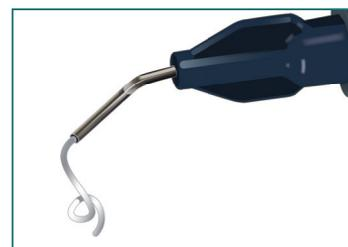
**4.** Réinsérer le piston et expulser une petite quantité de matériau à travers l'embout.
