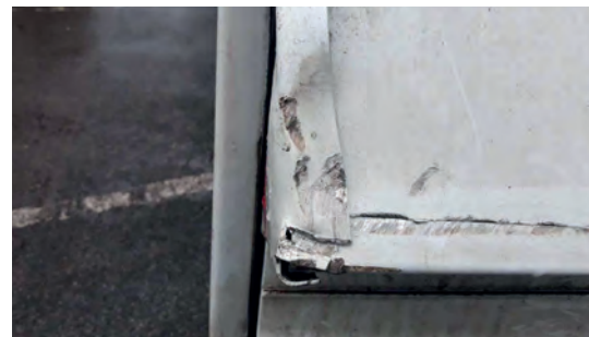
✗ Ladebordwand, Verformung, Brüche
