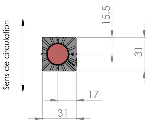
Couche drainante ou raccordement au réseau pluvial
