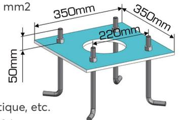
Le gabarit reste en place de niveau et doit reposer entièrement sur massif béton. Entraxe tiges de scellement 220 x 220 mm.
