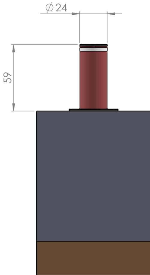
Couche drainante ou raccordement au réseau pluvial
