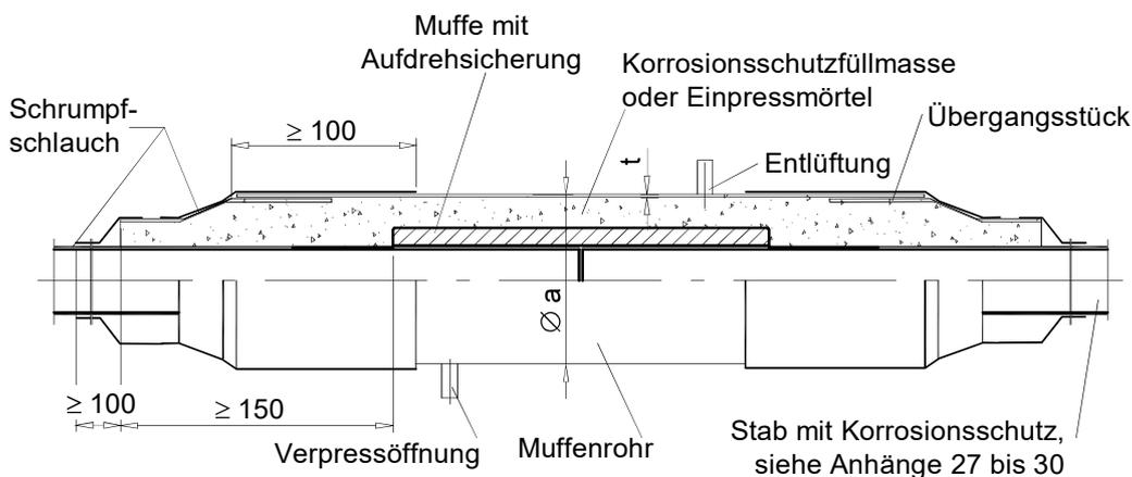
Entlüftung und Einpressöffnung nur anordnen falls erforderlich. Stahlrohr-Außenwand mit Korrosionsschutz.
