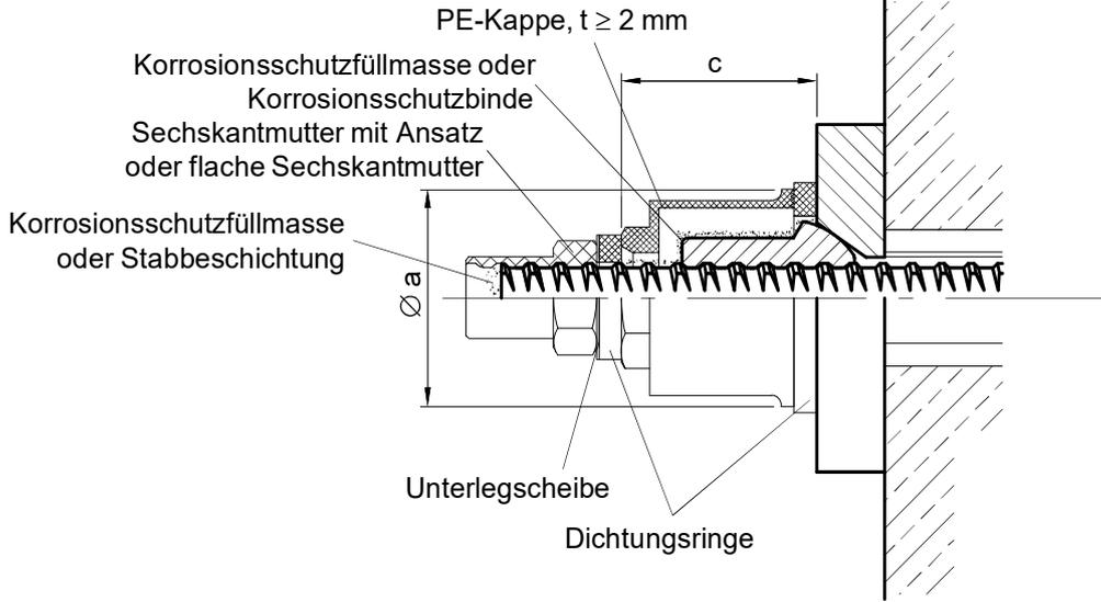
**Korrosionsschutz für hohe mechanische Beanspruchungen**
