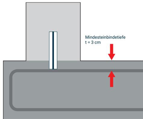
Sämtliche Fugenblechstöße sind durch die separaten Montagebügel K23 oder die Stoßklammer K23 zu fixieren.
