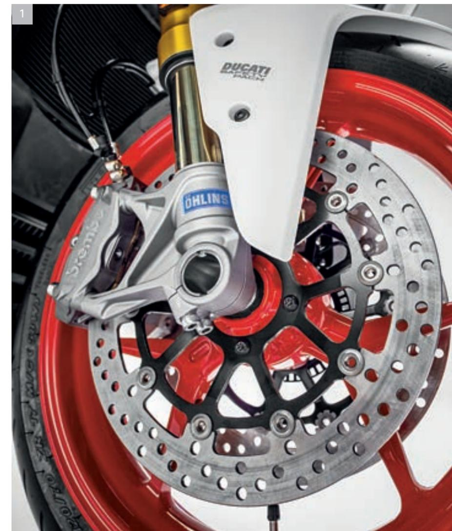
1 Fourche Öhlins complètement réglable, disques de 320 mm et étrier radial monobloc Brembo.
