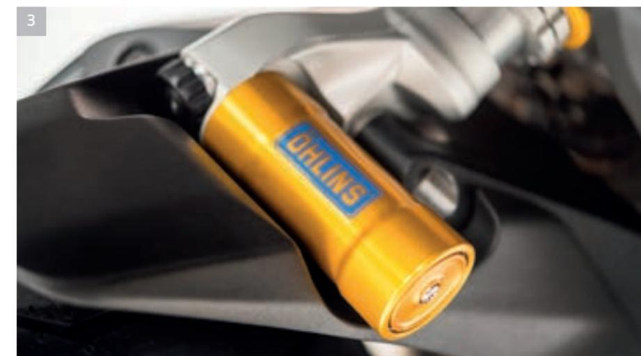
3 Mono-amortisseur Öhlins complètement réglable avec réservoir intégré à gaz.
