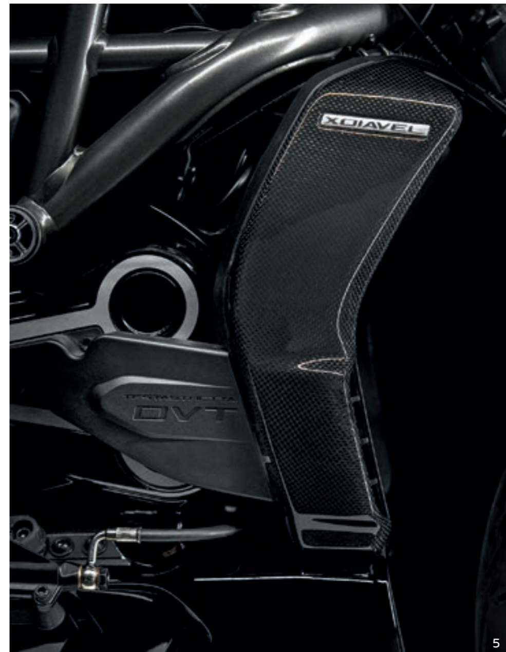
5_Cover en carbone pour radiateur à eau. 6_Cache embrayage en aluminium usiné dans la masse. 7_Garde-boue arrière en carbone.
