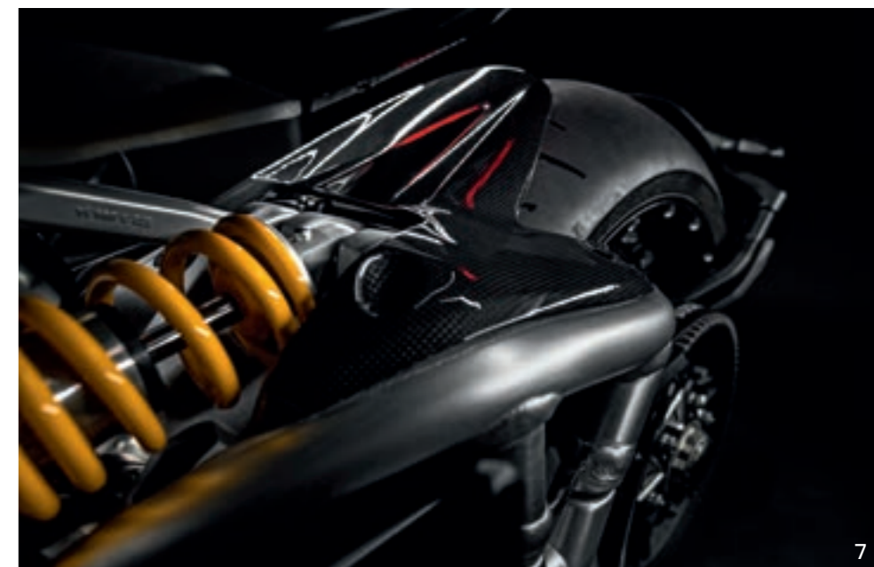
5_Cover en carbone pour radiateur à eau. 6_Cache embrayage en aluminium usiné dans la masse. 7_Garde-boue arrière en carbone.
