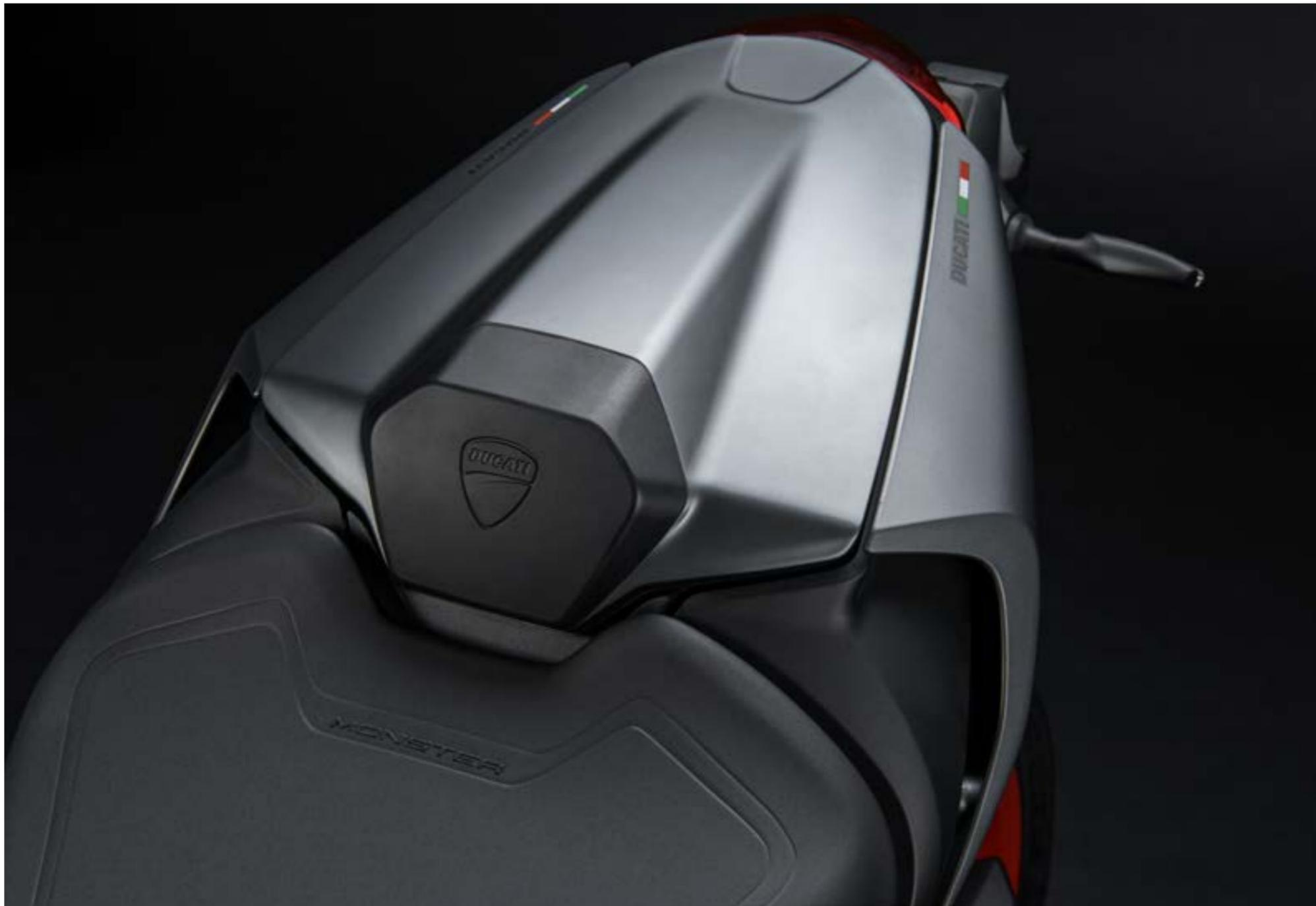
La coda corta, essenziale ma sinuosa e scultorea al tempo stesso, è formata da un telaio posteriore in polimero rinforzato in fibra di vetro lasciato a vista, con funzione sia strutturale sia estetica, e da due fianchetti verniciati.
