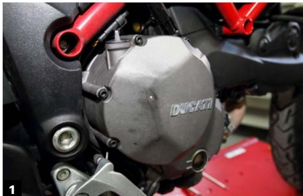
▲ La bulloneria, i vari componenti in acciaio e in lega leggera non hanno ossidazione. Ad eccezione del carter destro zona coperchio frizione, deteriorato dal contatto con lo stivale, la vernice di carrozzeria, motore e telaio è in ottimo stato
