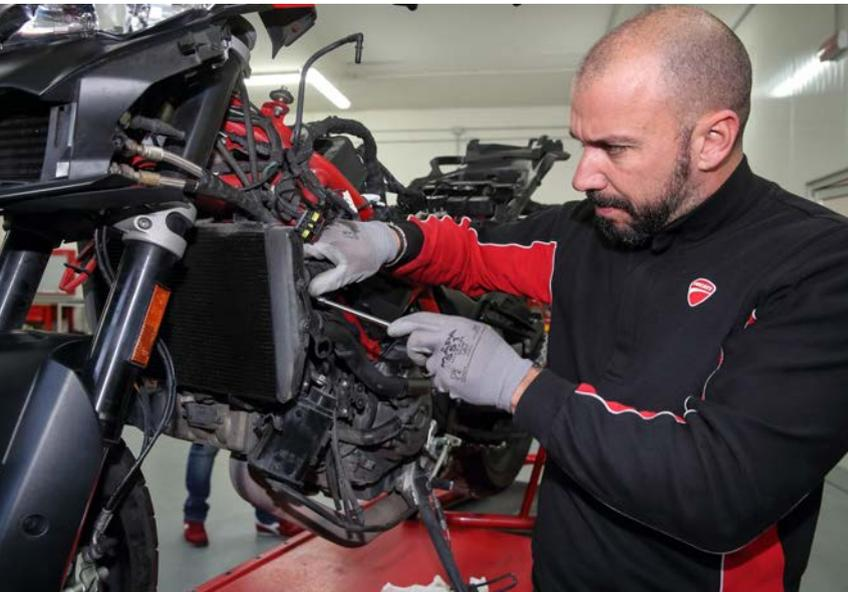
Senza dubbio, il motore della Multistrada è il propulsore più "in forma" tra tutti quelli smontati nei precedenti Long Test. Tutti i vari organi interni sono stati trovati in grande efficienza e abbiamo riscontrato usure minime. La conferma di questo stato di salute meccanica è il record di potenza e coppia massima ottenuto alla fine del nostro test
