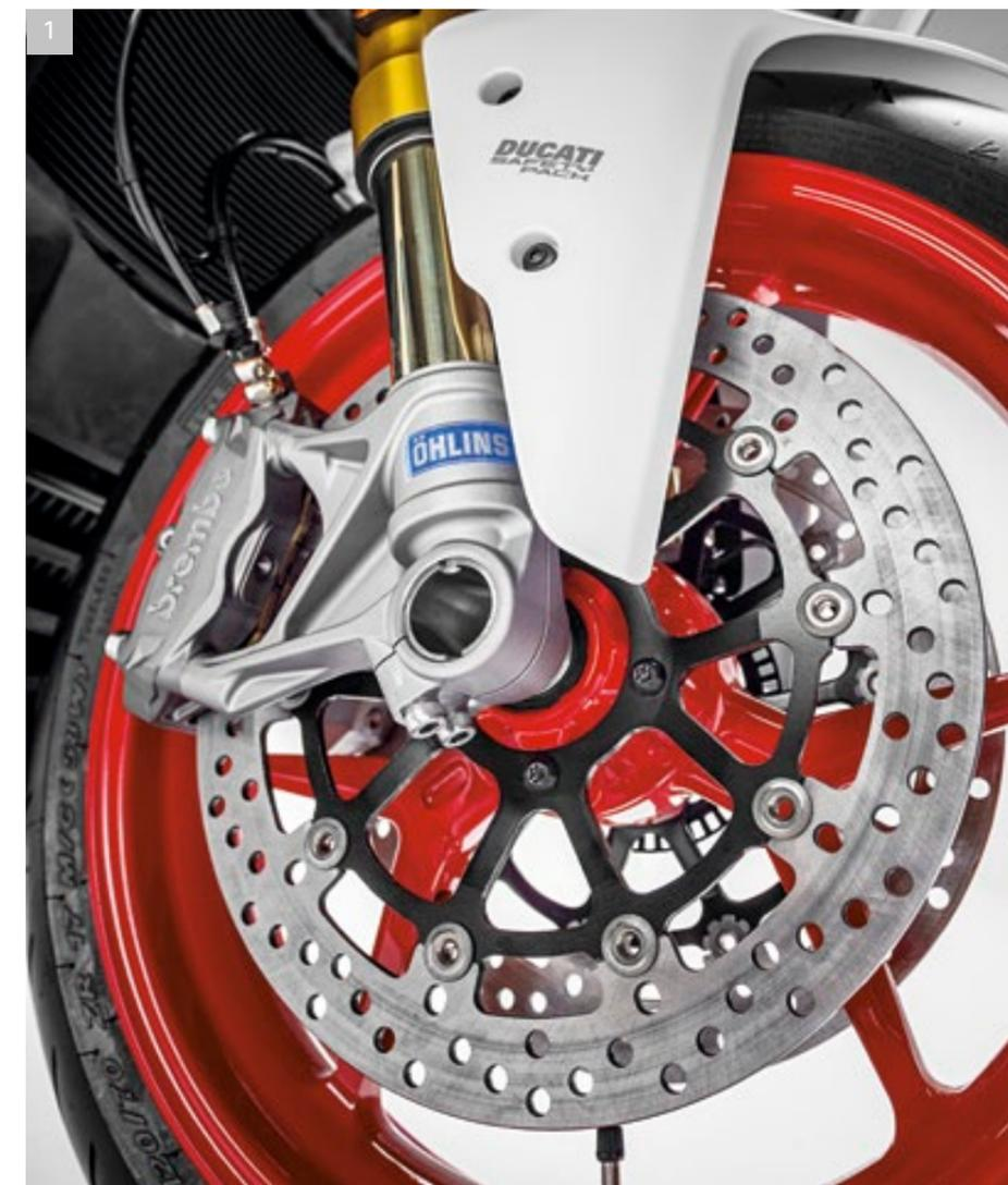
1 Forcella Öhlins completamente regolabile, dischi da 320 mm e pinza radiale monoblocco Brembo.
