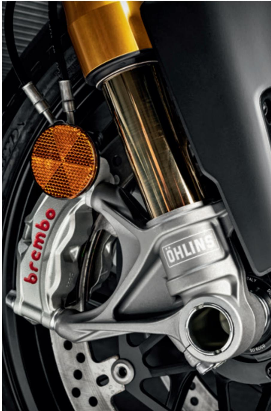
Desmosedici Stradale tramite un forgiato di alluminio. La versione S adotta, invece, il sistema Ducati Electronic Suspension EVO con forcella Öhlins NIX-30, ammortizzatore posteriore Öhlins TTX36 e ammortizzatore di sterzo sempre Öhlins con sistema di controllo Smart EC 2.0.
