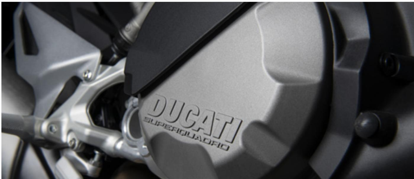
Potente ma godibile nell'uso stradale: il bicilindrico Superquadro da 955 cc dello Streetfighter V2 è capace di 153 cv a 10.750 giri e di 101,4 Nm di coppia massima a 9.000 giri. Conforme alla normativa Euro 5, il motore dello Streetfighter V2 condivide con quello della Panigale V2 l'impianto di scarico che si sviluppa integralmente sotto al motore.
