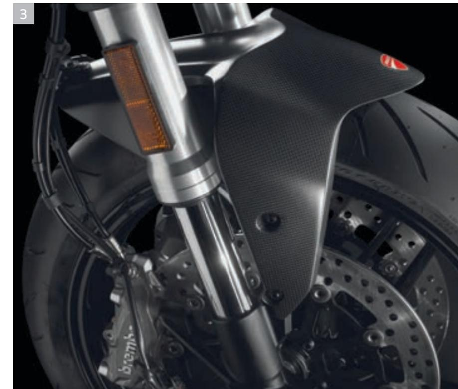
3 Garde-boue avant en fibre de carbone
