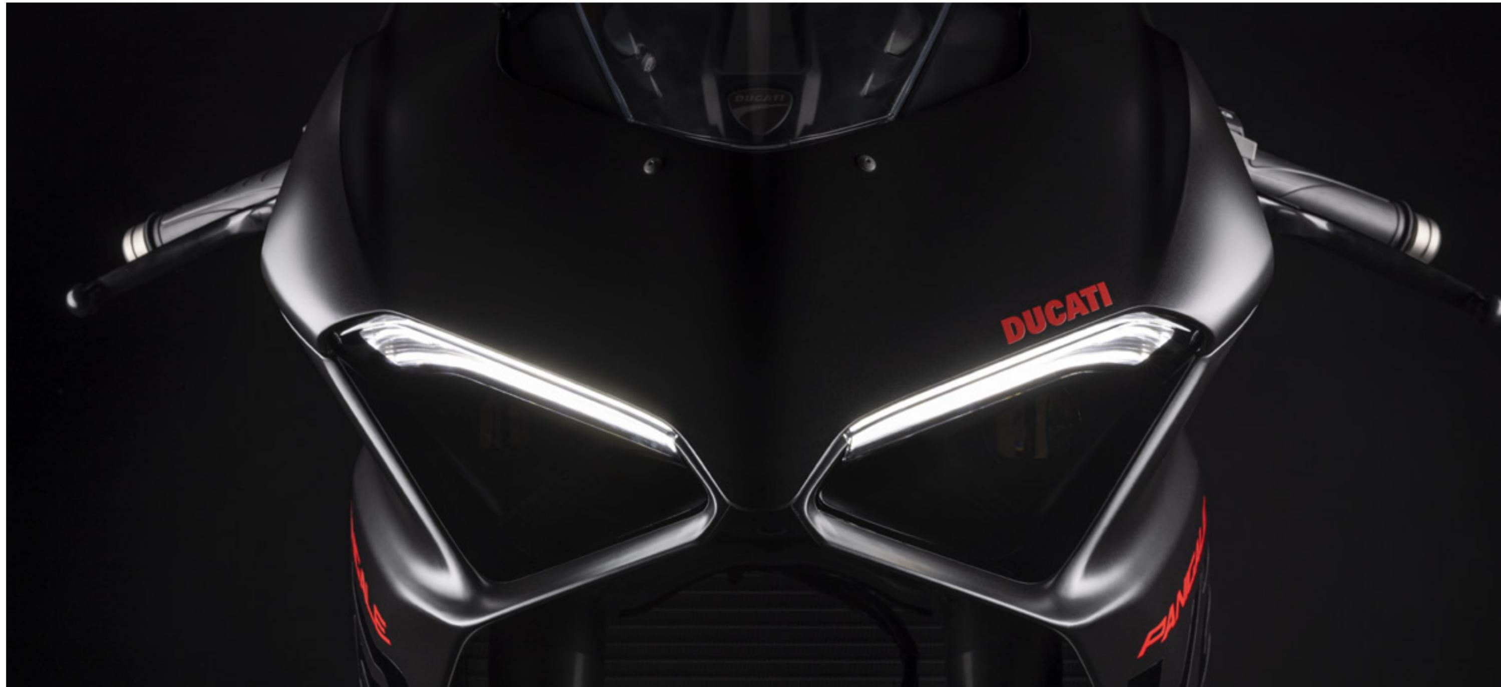
Il gruppo ottico anteriore si compone di un proiettore estremamente ridotto nelle dimensioni grazie all'adozione di due compatti moduli a LED che svolgono le funzioni di anabbagliante e abbagliante. La luce diurna (Daytime Running Light) dal profilo a V del doppio proiettore creano uno sguardo accigliato e costituiscono il moderno tratto distintivo delle sportive Ducati.
