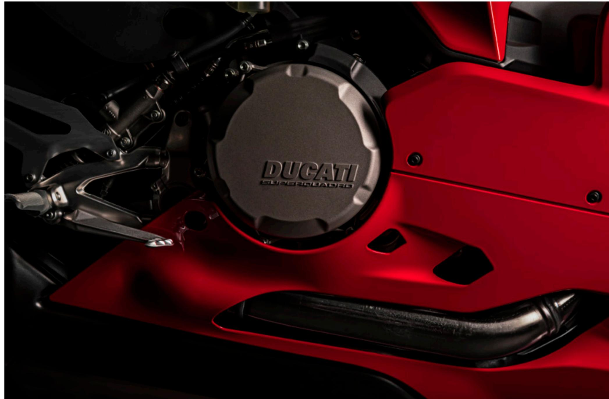
In condizioni di guida sportiva, con scalate repentine e forti trasferimenti di freno motore, lo stesso meccanismo riduce la pressione sui dischi della frizione, consentendole di lavorare nella modalità anti-saltellamento, di pura derivazione sportiva, che contrasta il bloccaggio della ruota posteriore con conseguente perdita di stabilità del retrotreno durante le scalate aggressive, offrendo il vantaggio supplementare di un'ottima modulabilità in staccata.
