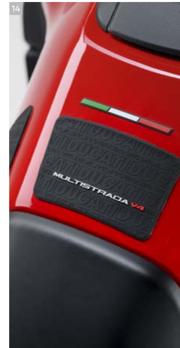
14 Protezione per serbatoio.
