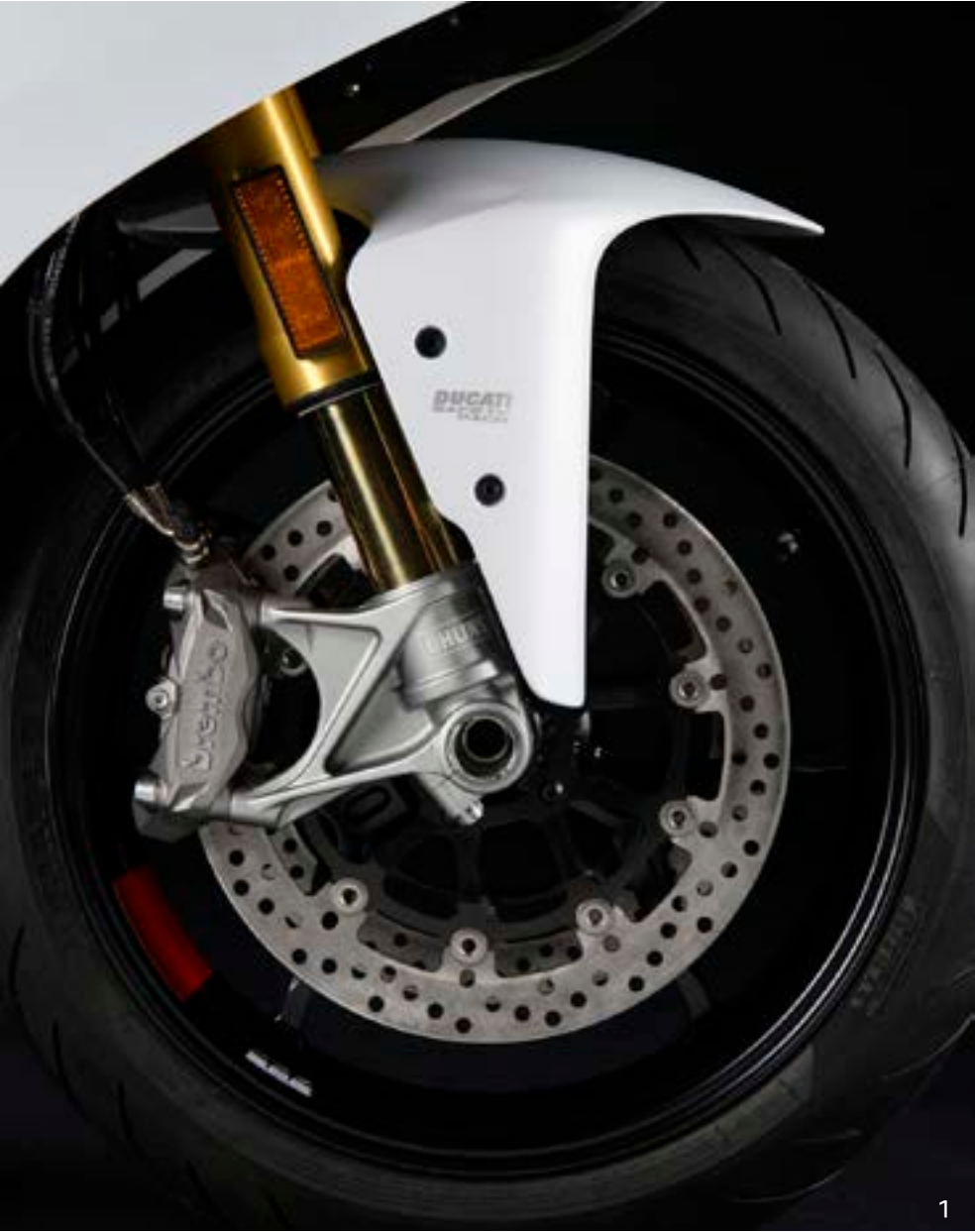
1_ Forcella Öhlins completamente regolabile Ø 48 mm con trattamento TiN degli steli. 2_ Mono-ammortizzatore Öhlins completamente regolabile con serbatoio integrato del gas. 3_Copri sella passeggero.
